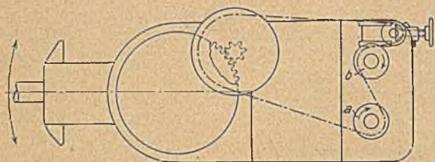
Abb. 9. Umschaltbare Kupplung für langsames Ein- und rasches Ausschwenken bei der Schrämmaschine von Knapp.
