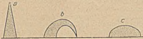
a Segerkegel im ursprünglichen Zustand, b erweichter Segerkegel nach deutscher, c geschmolzener Segerkegel nach amerikanischer Schmelzpunktbestimmung.
