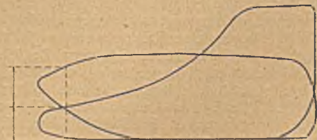
Abb. 4. Dampfdiagramme mit und ohne selbsttätige Füllungsregelung.
