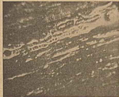
Abb. 13. Anschliff der Pechkohle im auffallenden Licht, Holzzellen zeigend. v = 50.
