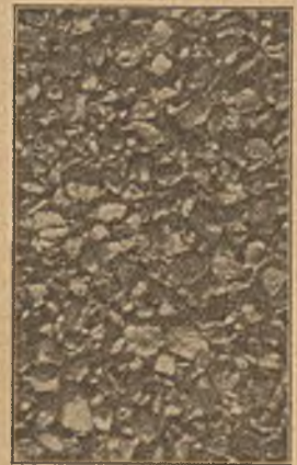
Abb. 3. Bergestücke als Setzerzeugnisse eines nach dem Verfahren von Spackeler und Glinz aufbereiteten Salzgitterer Erzes in etwa doppelter Vergrößerung.
