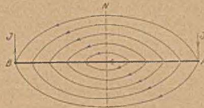
Abb. 2. Blanker Leiter in gleichförmigem Mittel.
