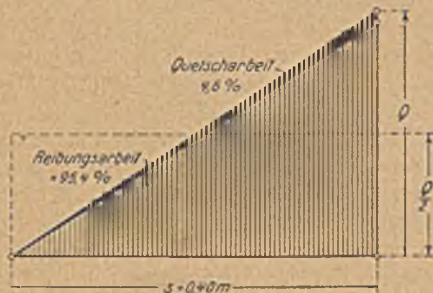
Abb. 23. Arbeitsdiagramm des Eisenstempels.
