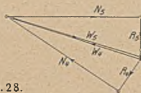
Abb. 26–28. Die Kräftebildung im Spannschloß des neuen Reibungsstempels.
