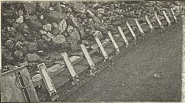
Abb. 5. Zurückführung der Schaber beim Förderband für Schrämmaschinenbetrieb.
