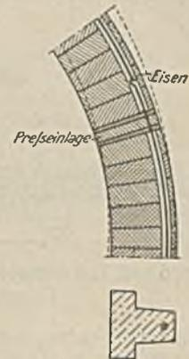
Abb. 5. Druckwirkung auf den gestaltänderungsfähigen Ausbau.
