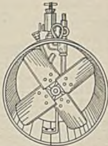
Abb. 18. Schraubenventilator von Frölich & Klüpfel ohne Leitvorrichtung.
