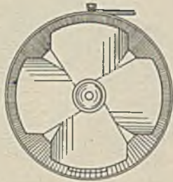
Abb. 26. Schraubenventilator von Korfmann mit vier Flügeln.
