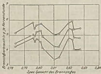
Abb. 3. Mittlerer Brennstoffverbrauch bei verschiedenen Lampen mit verschiedenen Brennstoffen.
