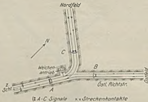
Abb. 2. Die Signalanlage Abzweig Gaskohlengruppe.
