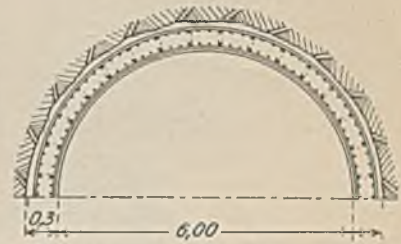
Abb. 1. Schachtausbau in Eisenbeton.
