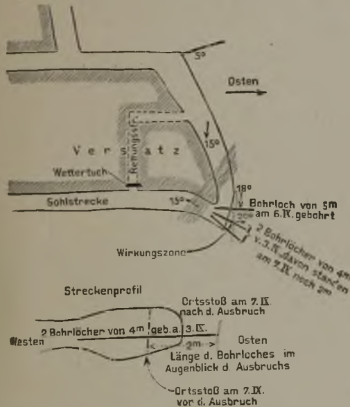
Abb. 2. Gasausbruch vom 7. Sept. 1909. Östliche Grundstrecke im Flöz Grande Godinette auf der 695 m-Sohle. Maßstab 1:600.
