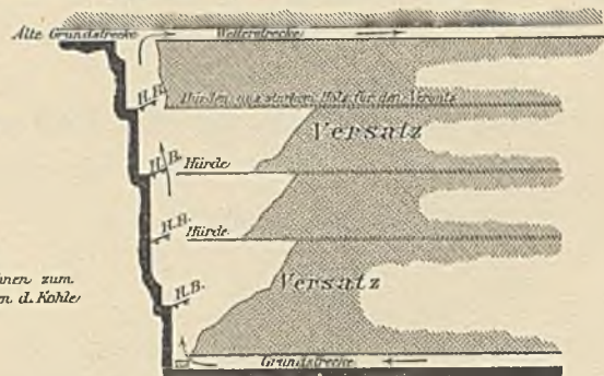
6. Methode: Gerade Stöße v. 10-12 m Höhe ohne Förderstr. im Versatz.
