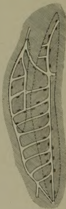
Abb. 20. Vorrichtung zweier Erzlinen zum Scheibenbruchbau
