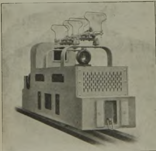
Abb. 6. Elektrische Einphasen-Wechselstromlokomotive mit Bügel-Stromabnehmern.
