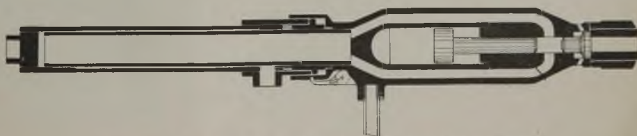
Abb. 12. Ingersoll M C - 22, schematischer Längsschnitt.
