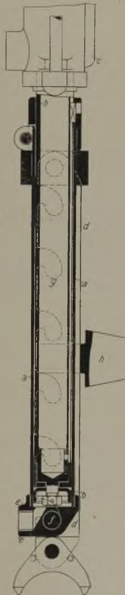
Abb. 9. Vorschubvorrichtung der Maschinenfabrik Westfalia.
