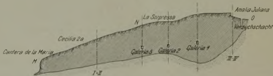
Abb. 14. Längsschnitt durch den Erzkörper der Grube La Sorpresa (Linie M-N-O der Abb. 13).
