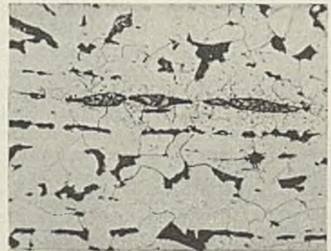
Abb. 13. Vergrößerung der in Abb. 12 mit einem Kreis bezeichneten Phosphideinschlüsse.  $v = 90$ .
