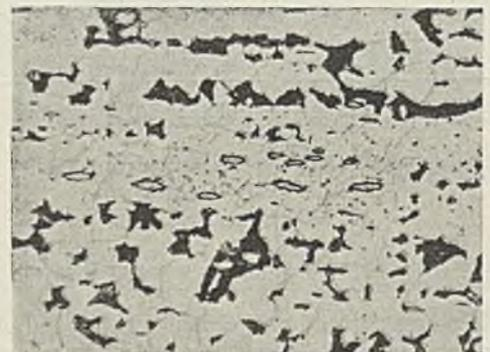
Abb. 14. Sulfide enthaltende Stellen.  $v = 90$ .
