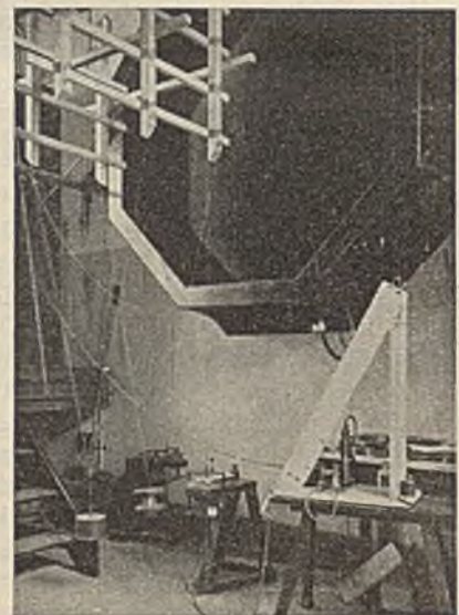
Abb. 3. Modell 1 im Windkanal mit den Einrichtungen zur Widerstandsmessung.
