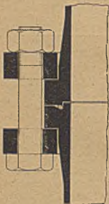
Abb. 1. Keilnutendichtung mit Gummiring.
