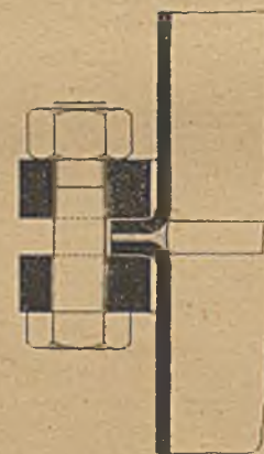
Abb. 4. Keilringdichtung bei einfach gebördelten Rohren.
