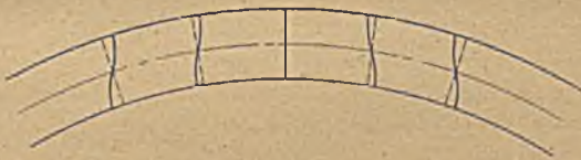
Abb. 3. Veränderungen der Querschnitte in einem verbogenen Draht.
