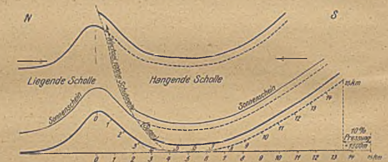
Abb. 10. Aufreißung des Wechsels am Sattelsüdflügel nach erfolgter Faltung.
