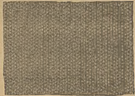
Abb. 5. Innig durchwebter Zellstoffriemen.
