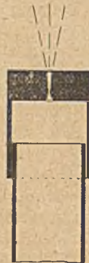
Abb. 1. Aufgezogene Stahlgußdüse mit gehärteter Oeffnung.
