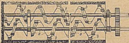
Die Maschine hat zwei mit Zähnen *b* besetzte Schraubenkörper *a*, von denen der eine rechts- und der andere linksgängig ist, und die so nahe nebeneinander angeordnet sind, daß ihre Gänge ineinander greifen. Beide Schraubenkörper werden durch einen gemeinschaftlichen Antrieb so bewegt, daß sie sich in entgegengesetzter Richtung drehen so bewegt, daß sie sich in entgegengesetzter Richtung drehen und beide das Bohrmehl aus dem Schram nach außen befördern.
