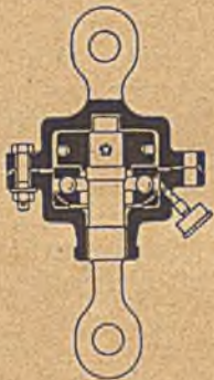
Abb. 2. Verbreiteter Wirbel zur Unterseilaufhängung.
