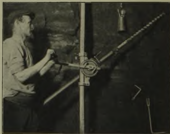
Abb. 2. Handbohrmaschine von Auer in Betrieb.
