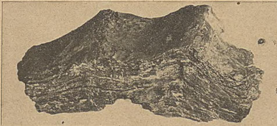
Abb. 1. Wellenberge gefalteter Kohle in Flöz 3 der Zeche Wehofen (1:4).
