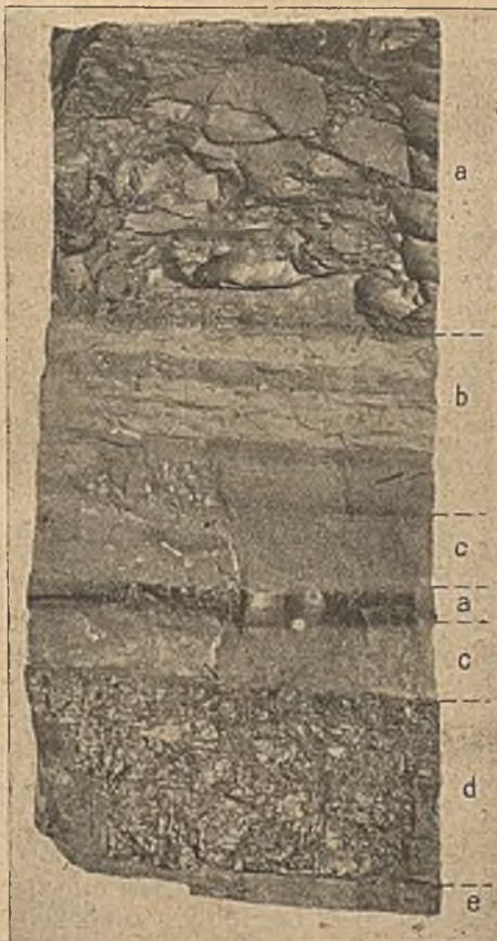
a Kennelkohle, b Eisenhaltiger Schiefer, c Eisenstein, d Streifenkohle, e Schieferton (Liegendes).
