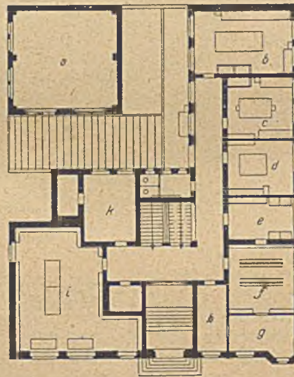
a Versuchsraum (Luft Raum), b Laboratorium I, c Laboratorium II, d Laboratorium III, e Wägezimmer, f Vorratsraum, g Geschäftsführung, h Vorratsraum, i Bücherei, k Schreibzimmer.
