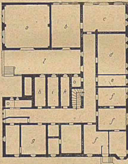
a Versuchsraum, b Schmiede, c Mechanische Werkstatt, d Maschinenraum, e Tischlerei, f Hausmeisterwohnung, g Heizung, h Dauerheizraum, i Aufbewahrungsraum für feuergefährliche Flüssigkeiten, k Vorratsraum, l Hofraum mit Glasdach.
