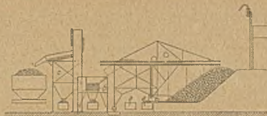
Abb. 43. Schaufelvorrichtung von Schöndeling für Schrägrampen.
