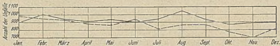
Abb. 3. Verteilung der Unfälle durch Stein- und Kohlenfall auf die einzelnen Monate nach Umrechnung auf 25 Arbeitstage und die Belegschaft des Jahres 1909.
