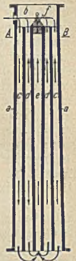
Abb. 8. Senkrechter Schnitt durch die Retorte der Premier Tarless Fuels Ltd.
