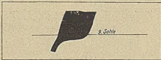
Abb. 9. Plötzliche Abnahme der Mächtigkeit des »criadero del sur« bei Rio Tinto. (Nach Gonzalo y Tarin, Bd. 2, S. 190.)
