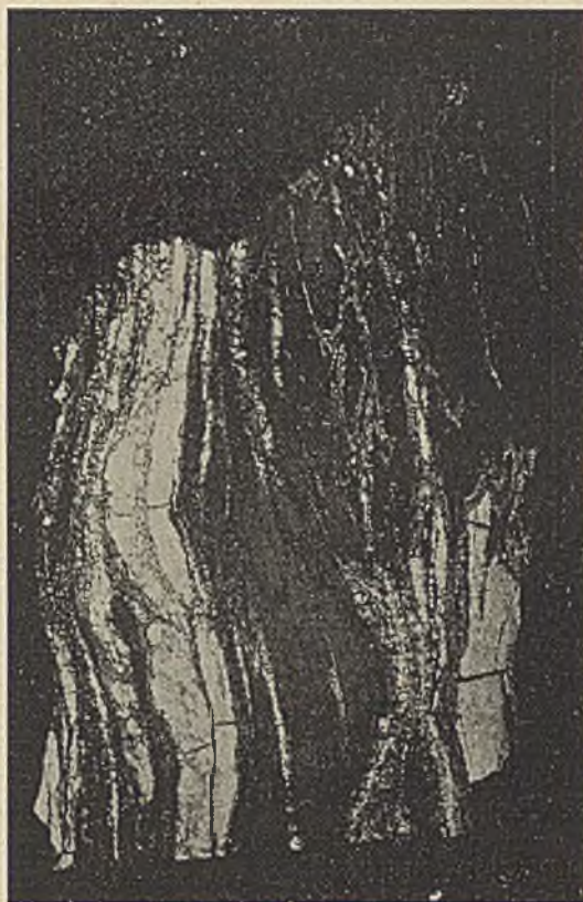
Abb. 16. Tonschiefer (dunkel), von Pyrit durchzogen. Cuña aus der »massa grande« von Grube Sotiel Coronada. v = 3 . Polierte Fläche bei gespiegeltem Licht aufgenommen.
