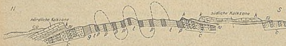
l Tonschiefer, Serizitschiefer, Quarzite und klastische Gneise der erzführenden Serie, p Porphyroide, g Grünschiefer, c rote Schiefer und Grünwackenkonglomerate des Karbons, w Werfener Schichten, k Triaskalk, co Eozän
