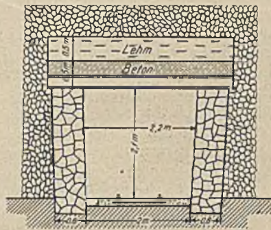
Abb. 21. Streckenausbau im Bergeversatz.
