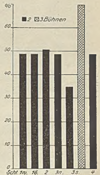
Abb. 15. Zeitersparnis bei Verwendung mehrerer Abzugsbühnen in Hundertteilen des Zeitaufwandes bei 1 Abzugsbühne.
