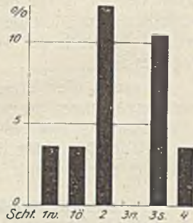
Abb. 17. Zeitersparnis bei Verwendung ineinanderschließbarer Türen in Hunderteilen des Zeitaufwandes bei gewöhnlichen Türen.
