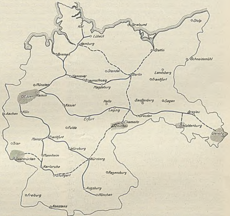
Das geplante Hauptverteilungsnetz der Ferngasversorgung.
