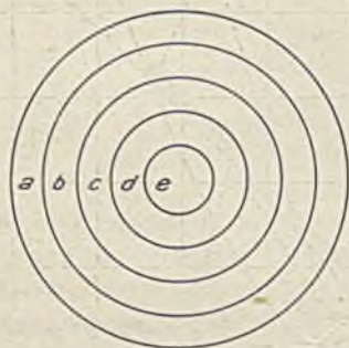
Durchmesser: a = 490 , b = 400 , c = 300 , d = 200 , e = 100 mm. Abb. 2. Versuchsanordnung.
