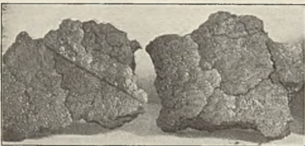
Abb. 2. Eindrücke in ursprünglich plastischem Koks.
