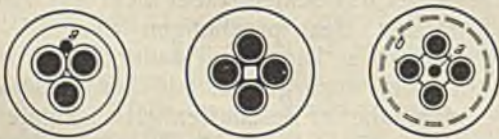
Abb. 6. Alte, neuere und neuste Bauart von Schleppkabeln.
