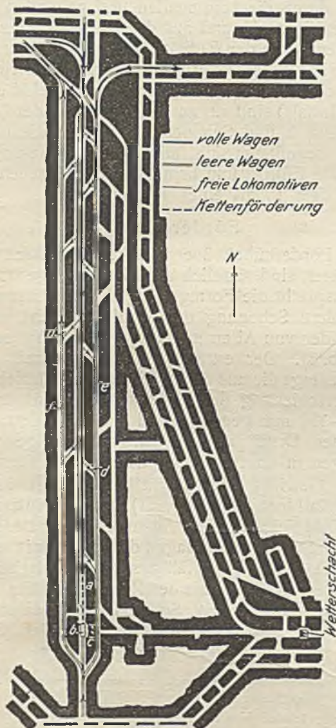
Abb. 2. Füllortanlage der Grube Orient Nr. 2.
