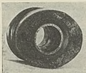
Abb. 11. Infolge erhöhter einseitiger Beanspruchung mit Dauerbruchscheinung gebrochener Abbauhammerzylinder.
