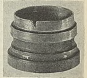
Abb. 7. Infolge falscher Werkstoffbehandlung und starker Beanspruchung angebrochener Rohrschieber eines Abbauhammers.
