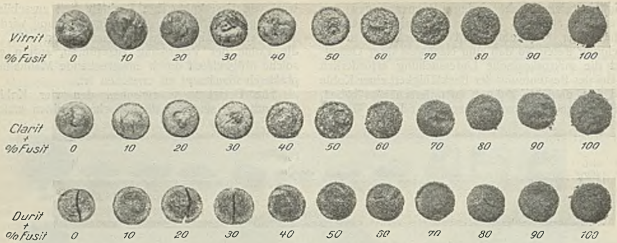
Abb. 7. Von oben gesehene Tiegelkoksproben aus den Mischungen Vitrit-Fusit, Clarit-Fusit und Durit-Fusit.
