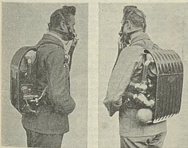
Abb. 1 und 2. Anordnung und Tragweise des Gasschutzgeräts Audos Modell 26 D.
