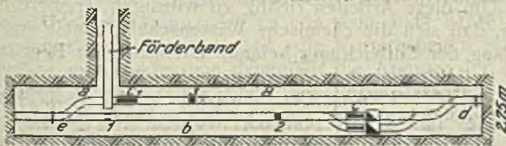
Abb. 9. Anordnung der Ladestelle bei Band- und Stapelförderung. a leere, b volle Bahn, c und c 1 Auf- und Durchschiebevorrichtungen, d Ablaufberg, e Federweiche mit Ablaufberg. 1 ein Lader, 2 Bedienung für c, d und Stapel, 3 Bedienung für c 1 und e.
