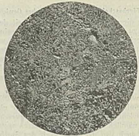
Abb. 6. Nat. Gr. Im CTG-Ofen aus Arszakohle gewonnener Schwelkoks.
