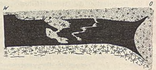
Abb. 3. Erosionserscheinung im Flöz 8.
