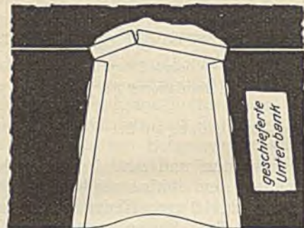
Abb. 11. Knickung der Kappe in Kladno.
