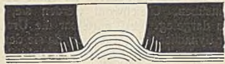
Abb. 8. Hochpressen des Liegenden mit Schleppung der Kohle (Fürstenschächte, Fürstl. Pleßische Verw. O. S.).
