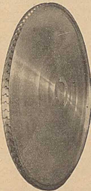
Fig. 12. Laufrad einer A.-E.-G.-Dampfturbine mit einfachem Schaufelkranz.
