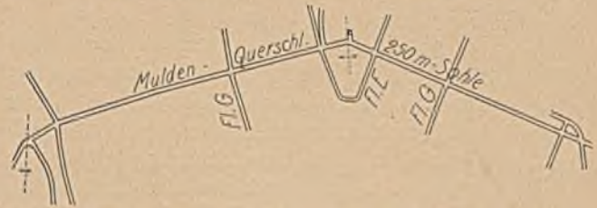
Fig. 15. Muldenquerschlag auf der 250 m-Sohle der Grube Maria, sich auf den einzelnen Sohlen auf die Dauer nicht decken würden. Die Brechpunkte würden ja in die Sattel- und Muldenlinien zu liegen kommen; diese liegen aber durchweg in einer geneigten, nicht in einer seigeren Ebene.
