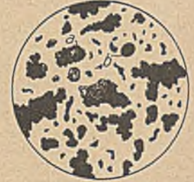
Abb. 2. Durch Explosion veränderter Kohlenstaub. (66 fache Vergrößerung.)
