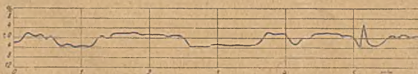
Abb. 3. Umlaufschwankungen bei normalbelastetem Mischdampfbetrieb.
